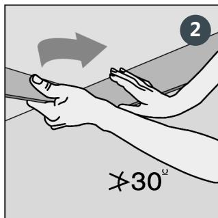
Drücken Sie die nächste Bodendiele im Winkel an die erste Diiele und drücken Sie anschließend die Diiele auf den Boden. Verfahren Sie in der gleichen Weise mit der gesamten ersten Reihe.
