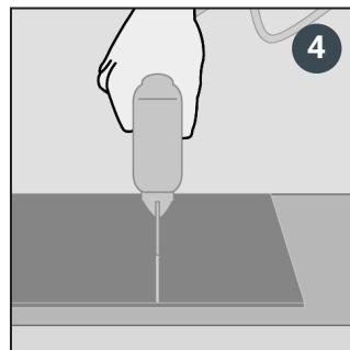
Sägen Sie die Länge zu, am besten mit Hilfe einer Stichsäge. Legen Sie die Diiele mit der Dekorseite auf die Sägeunterlage. Als Alternative kann eine feingesäzte Handsäge benutzt werden, aber dann muss die Dekorseite nach oben zeigen.
