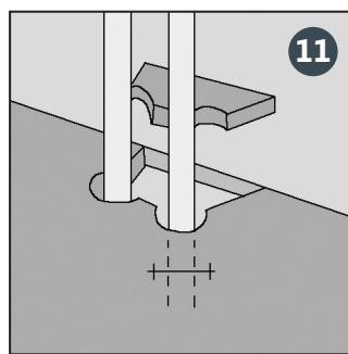
Bohren Sie entsprechende Löcher in die Dielen. Die Bohrungen sollten 20 mm größer im Durchmesser sein als die Rohre. Setzen Sie das ausgesägte Stück mit Leim wieder ein. Decken Sie die Fuge anschließend mit einer Heizkörperrosette ab.
