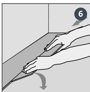
Drücken Sie die Längsseite der ersten Diiele der zweiten Reihe im Winkel gegen die davor liegende Diiele. Pressen Sie die Diiele weiter nach vorne und legen Sie sie gleichzeitig an den Boden an.
