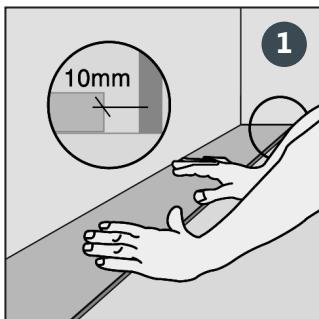
Legen Sie das erste Element entlang der Wand aus. Dabei werden die Fenderseiten gegen die Wand gelegt. Achten Sie darauf, dass Sie ca. 10 mm Abstand zwischen der Stirnseite der Dielen und der Wand haben. Der Abstand der Längsseite von der Wand (ca. 10 mm) kann später festgelegt werden, wenn drei Reihen verlegt worden sind.
