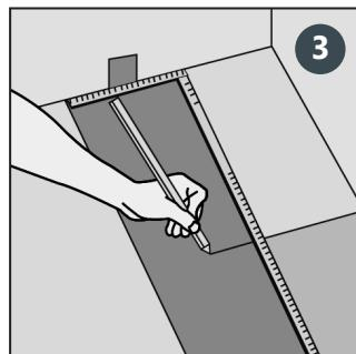
Legen Sie die letzte Diiele mit der Unterseite nach oben, die Stirnseite ohne Verriegelungsleiste der Wand zugewandt. Der Abstand zur Wand soll ca. 10 mm betragen. Markieren Sie die Stelle, an der die Diiele abgesägt werden soll.
