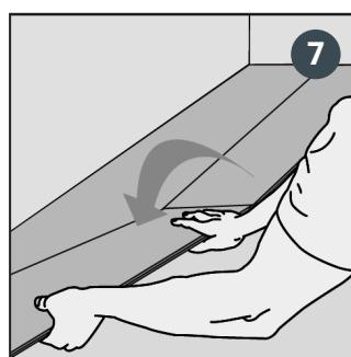
Drücken Sie stirnseitig die nächste Diiele schräg in die erste und legen Sie diese auf den Boden. Dabei soll die Längsseite auf der Verriegelungsseite der vorhandenen Diiele gelegt werden.
