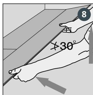
Heben Sie die Diiele (zusammen mit der vorher gelegten Diiele in der gleichen Reihe) etwa 30 mm an der Vorderkante an und drücken Sie diese in die Dielenreihe hinein. Wenn die Längskanten aufeinander stoßen, legen Sie die Dielen auf den Boden.
