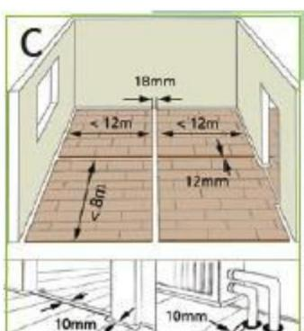
In Räumen, die in der Längsrichtung mehr als 12 m Länge und/oder in der Querrichtung mehr als 8 m Breite messen, muss zusätzlich ein Dehnungsprofil eingesetzt werden. Dies gilt auch für Türöffnungen, Raumdurchgänge, Mauervorsprünge und verinkelte Räume.
