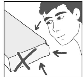
Achten Sie darauf, dass die Pakete innerhalb einer Verlegefläche aus der gleichen Charge stammen, um Glanzgradunterschiede und Farbabweichungen zu vermeiden. Die Chargennummer finden Sie auf den Etiketten der Verpackungen. Diese sind bei Nachbestellungen mit anzugeben. Vermeiden Sie direkte Sonneneinstrahlung sowohl während der Akklimatisierung als auch während der Verlegung.
