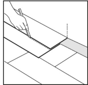
Heizkörper (oder aufsteigende Bauelemente in der Fläche): Schneiden Sie das Element entsprechend zu. Bei Heizkörperrohren geben Sie bitte mind. 5 mm zum Durchmesser des Heizungsrohres dazu.
