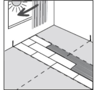
Ziehen Sie bei der weiteren Verlegung abschnittsweise den Klebstoff nach Herstellerangaben vor und fügen Sie anschließend die nächsten Elemente exakt zusammen, indem Sie die Elemente mit leichtem Druck in das Kleberbett legen. Wichtig ist es, den Bodenbelag fugendicht und spannungsfrei zu verlegen. Die Teilflächen sind unmittelbar vor der weiteren Verlegung mit einer geeigneten Handwalze anzuwalzen.
