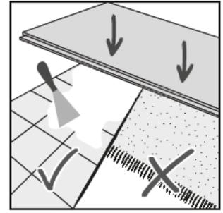
Auch bei Designböden 555 Wooden Styles, ist die richtige Vorbereitung des Untergrundes ein wesentlicher Bestandteil einer erfolgreichen Installation. Rauheit oder Unebenheiten des Untergrundes können sich durch den neuen Fußbodenbelag drücken und zu erhöhtem Verschleiß an den entsprechenden Stellen führen. Bei einer unzureichenden Vorbereitung kann es zu einem unbefriedigenden Gesamteindruck bis hin zu deutlicher Fugenbildung kommen.
