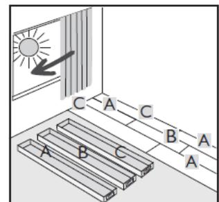
Vor der Verlegung der Elemente muss die Mittelachse des Raumes festgelegt werden. Diese ist abhängig von Raumform und Design Ihres Bodens. Starten Sie mit dem Verlegen in der Mitte des Raumes. Dielen werden immer von der Mitte aus zum Rand hin festgedrückt. Die Verlegerichtung wird entsprechend des Verlegeplans und ggf. unter Berücksichtigung der Verlegepfeile festgelegt
