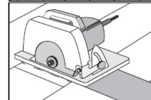
Zur Vorbereitung des Ersatzelements schneiden Sie sowohl an der Stirn-, als auch an der Längsseite vorsichtig die Feder ab, sodass die Verriegelungsnut nicht beschädigt wird.
