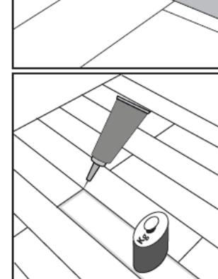
Nun tragen Sie den D3 Weißleim auf die Längs-, und Stirnseite des präparierten Elements sowie auf dem verbleibenden Clickmechanismus der angrenzenden Elemente auf. Anschließend führen Sie das präparierte Element von der Nut- zur Federseite hin ein und beschweren es, bis der Leim abgebunden hat.
