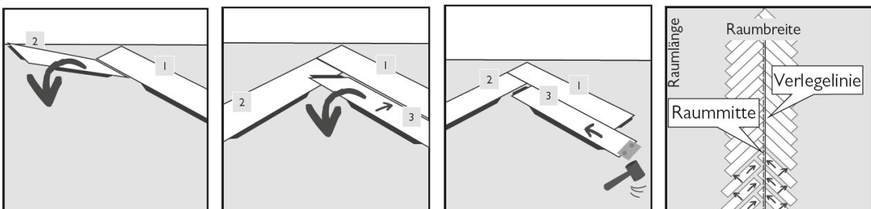
Überprüfen Sie sorgfältig die Fugen zwischen den Elementen nach jedem Element, das hinzugefügt wird. Es sollten keine Überstände zu fühlen sein.
