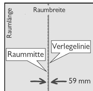
Starten Sie mit der Verlegung der ersten Elemente an der oberen Wand. Montieren Sie die Elemente präzise und in der Reihenfolge wie auf der Zeichnung angegeben.
